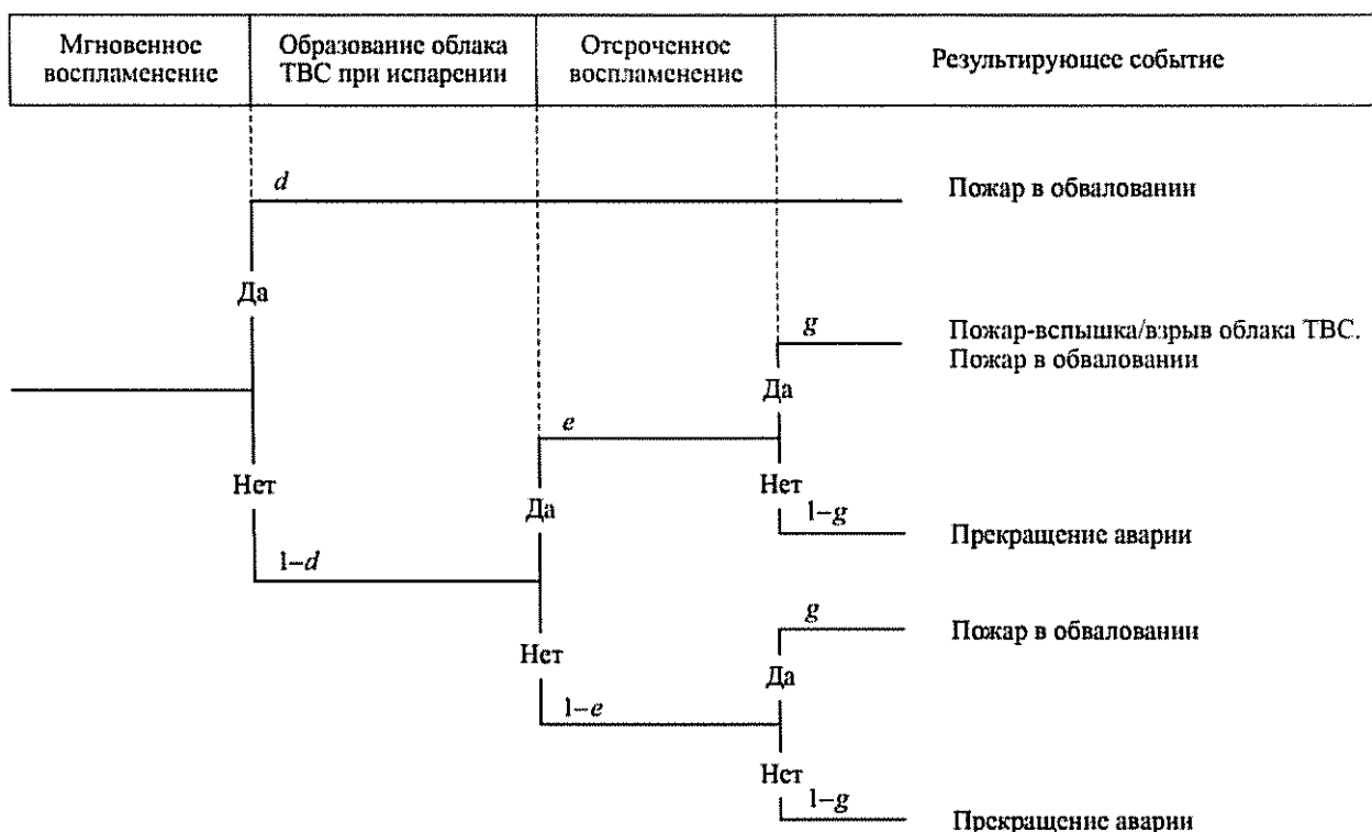
Рис. 4. «Дерево событий» разрушения/перелива подземного резервуара (сценарий А 4 )
